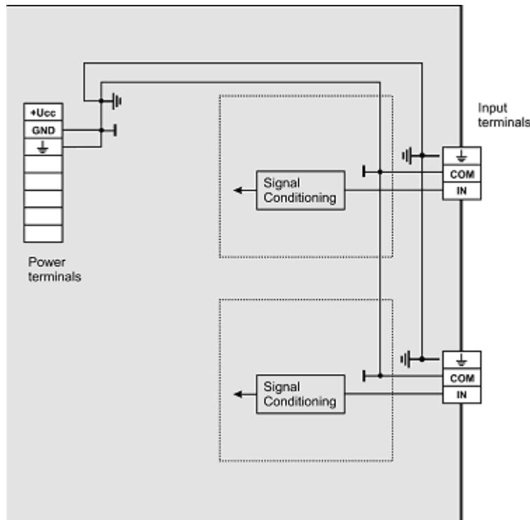
2. Vstup pro dvouvodičové připojení pasivního snímače - typ vstupu A0:
