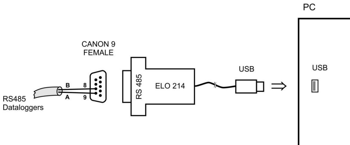
*Poznámka: pokud stínění kabelu není spojeno s uzemněním některé ústředny (viz obr. výše), pak jej propojte na pin č. 5 konektoru CANON.*
