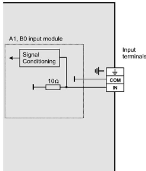
*Vstupy pro měření vyšších proudů (1A a 5A) se liší velikostí bočníku. Napěťové vstupy mají místo bočníku odporný dělič. Vstupy pro měření odporu mají na svorku IN přivedeno přes vhodný rezistor referenční napětí.*
