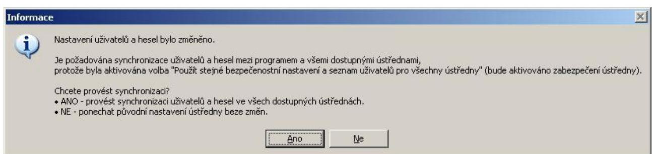
Během procesu synchronizace program v každé ústředně zapne zabezpečení. Změna uživatelů a hesel v ústředně vyvolává nutnost smazání záznamu, proto je uživatel na toto během synchronizace upozorněn a může před smazáním paměti stáhnout aktuální záznam z ústředny.
