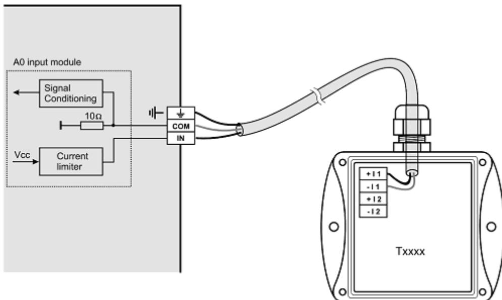
Poznámka: Jako pasivní snímače jsou takto připojitelné snímače teploty a vlhkosti Comet.
