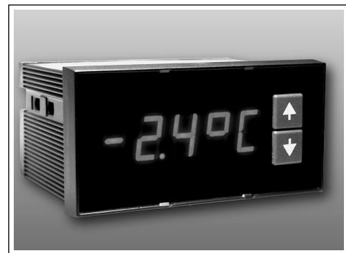
Zobrazovač PES-EX04 je koncipován jako extrémně jednoduchý a přitom efektivní terminál na zobrazování i nastavování číselních hodnot. Displej je tvořen pěti 7-segmentovými číslicovkami LED s výškou znaku 14 mm, červené barvy. Mechanické provedení počítá se zástavbou do otvoru v panelu.
