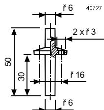
Ke každému přístroji se dodávají 2ks tlakových odběrů (PVC)
