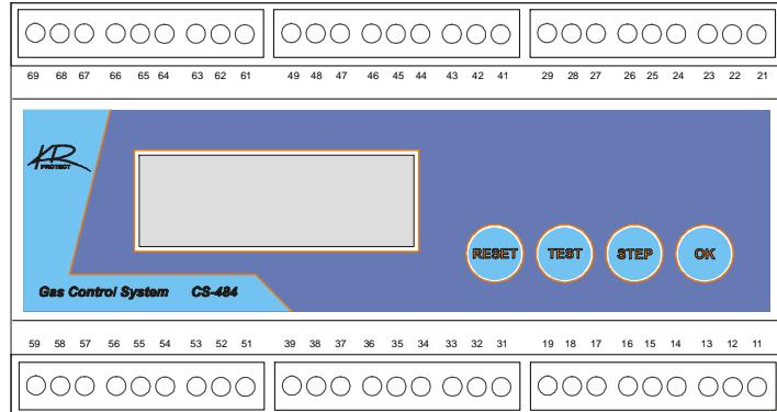
Ústředna CS-484-2 je čtyřstavový regulátor s programovatelnou vazbou 2 analogových vstupů a 5 výstupů. Je předurčena k vyhodnocování výstupních signálů z plynových detekčních čidel nejen v prostorách garážových stání, ale i v dalších průmyslových aplikacích detekce hořlavých, výbušných a toxických plynů. Ústředna umožňuje výpočet a zobrazení hodnot **PEL – přípustných expozičních limitů** toxicických plynů předepsaných sbírkou zákona č.178/2001.
