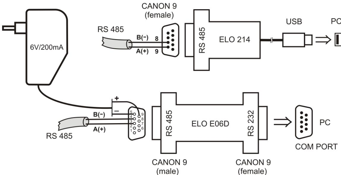
Pro připojení snímače s rozhraním RS485 přes USB port PC je jako volitelné příslušenství nabízen převodník **ELO E214**, jehož součástí jsou i rezistory pro definici klidového stavu a zakončovaní rezistor. Vnitřní rezistory lze připojit ke sběrnici pomocí propojek na konektoru CANON, sběrnice se připojí na vývody č.8 B(-) a č.9 A(+). Podrobné informace jsou v návodu k převodníku.
