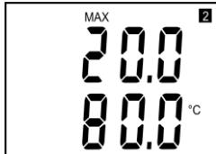
Po následujícím stisku tlačítka se objeví hodnoty pro horní bod přiřazení, zde 20 mA odpovídá teplota okolí 80 °C.
