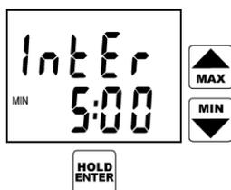
Nyní přístroj zobrazuje nastavený interval ukládání naměřených hodnot do paměti. Je-li třeba jej změnit, provede se nové nastavení klávesami se šipkami. Interval 10 sec je zobrazen jako **MIN 0:10**, minutové intervaly jsou zobrazeny **MIN x:00** a intervaly hodinové **x:Ho**. Nastavený interval se potvrdí kl. ENTER. Upozornění: je-li nastaven manuální typ záznamu, je tato položka přeskočena (interval se nenastavuje).
