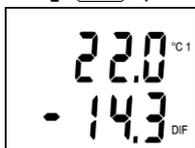
Přístroj poté zobrazuje teplotu 1. kanálu a rozdíl teplot obou kanálů (řádek označený zkratkou DIF). Rozdíl teplot ( $t_{dif} = t_1 - t_2$ ) se zobrazí pouze tehdy, jsou-li připojeny obě sondy.
