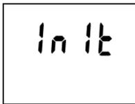
Došlo-li od posledního nastavení času ve vnitřních hodinách přístroje k poklesu napětí baterie pod kritickou mez nebo k jejímu odpojení na dobu delší než cca 1 min, proběhne po zapnutí nová inicializace přístroje (nápís INIT může svítit až 12 s !).
