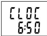
Po ukončení inicializace se přístroj přepne do režimu zobrazení času, aby upozornil na případně nesprávný vnitřní čas. Nové nastavení času se provádí pomocí počítače. Stiskem kl. MENU je možné přístroj přepnout do režimu zobrazení hodnot měřených veličin.
