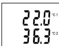
Na horním řádku displeje se zobrazuje teplota 1. kanálu (°C 1), na dolním řádku teplota 2. kanálu (°C 2),
