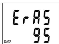
Tím je spuštěna procedura mazání, která trvá cca 16 s a její průběh je indikován na displeji průběžným zobrazením procentuální hodnoty velikosti už vymazané paměti (číslicemi 0 až 100).
