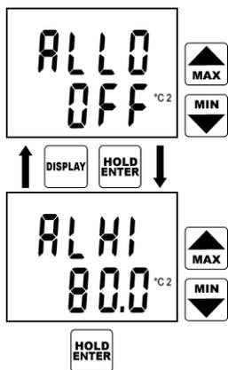
Přístroj dále nabízí nastavení alarmu další veličiny (teplota 2. kanálu). Postup nastavení alarmů všech veličin je zcela totožný s výše uvedeným nastavením alarmu teploty 1. kanálu. Nebude-li alarm pro danou veličinu využíván, je možno jej vypnout nastavením dolní meze alarmu na její maximální nastavitelnou hodnotu, jak je tomu v tomto případě. Číselná hodnota dolní meze alarmu se pak změní na nápis OFF.
