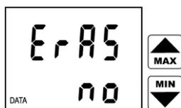
Přístroj dále nabízí možnost vymazání záznamové paměti (ERAS). Nemá-li být paměť před spuštěním záznamu vymazána, stačí potvrdit klávesou ENTER nabízenou volbu ERAS NO (nemazat).
