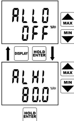
Přístroj dále nabízí nastavení alarmu další veličiny (relativní vlhkost). Postup nastavení alarmů všech veličin je zcela totožný s výše uvedeným nastavením alarmu teploty. Nebude-li alarm pro danou veličinu využíván, je možno jej vypnout nastavením dolní meze alarmu na její maximální nastavitelnou hodnotu, jak je tomu v tomto případě. Číselná hodnota dolní meze alarmu se pak změní na nápis OFF.
