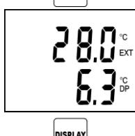
Přístroj poté zobrazuje teplotu dotykové sondy (symbol EXT) a teplotu rosného bodu (symbol DP).
