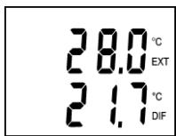
Po dalším stisku klávesy DISPLAY se zobrazí teplota externí sondy (EXT) a rozdíl teploty externí sondy a teploty rosného bodu (symbol DIF). Tento rozdíl je definován jako  $t_{dif} = t_{ext} - t_{dp}$ .
