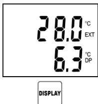
Přístroj poté zobrazuje teplotu externí sondy (symbol EXT) a teplotu rosného bodu (symbol DP). Není-li správně připojena ext. sonda nebo je její teplota mimo měřitelný rozsah, zobrazí se na odpovídajícím řádku pomlčky (--).
