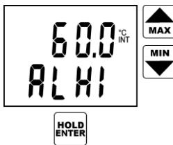
Nápis ALHI indikuje nastavovanou horní mez téhož alarmu. Postup nastavení hodnoty na požadovanou velikost je totožný s nastavením dolní meze alarmu. V případě potřeby je možno se vrátit zpět na nastavení dolní meze téhož alarmu klávesou DISPLAY. Stiskem klávesy ENTER je nastavená hodnota horní meze potvrzena.
