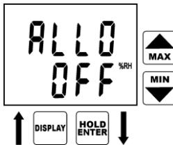
Přístroj dále nabízí nastavení alarmu další veličiny (relativní vlhkost). Postup nastavení alarmů všech veličin je zcela totožný s výše uvedeným nastavením alarmu teploty. Nebude-li alarm pro danou veličinu využíván, je možno jej vypnout nastavením dolní meze alarmu na její maximální nastavitelnou hodnotu, jak je tomu v tomto případě. Číselná hodnota dolní meze alarmu se pak změní na nápis OFF.
