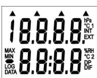
Bude-li používána externí teplotní sonda, je třeba ji zapojit ještě před zapnutím přístroje. Přístroj se zapíná stiskem klávesy ON/OFF. Po zapnutí se na okamžik rozsvítí všechny znaky displeje pro jeho případnou kontrolu. Je-li klávesa ON/OFF při zapnutí přidržena stisknuta, svítí všechny znaky displeje až do uvolnění klávesy ON/OFF.
