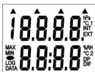
Před zapnutím přístroje je nutno připojit do konektoru externí sondu. Sonda je zkalibrována s konkrétním přístrojem a není možné ji zaměnit za jinou (vlastníte-li více přístrojů tohoto typu). Přístroj se zapíná stiskem klávesy ON/OFF. Po zapnutí se na okamžik rozsvítí všechny znaky displeje pro jeho případnou kontrolu. Je-li klávesa ON/OFF při zapnutí přidržena stisknuta, svítí všechny znaky displeje až do uvolnění klávesy ON/OFF.
