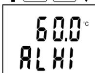
Nápis ALHI indikuje nastavovanou horní mez téhož alarmu. Postup nastavení hodnoty na požadovanou velikost je totožný s nastavením dolní meze alarmu. V případě potřeby je možno se vrátit zpět na nastavení dolní meze téhož alarmu klávesou DISPLAY. Stiskem klávesy ENTER je nastavená hodnota horní meze potvrzena.
