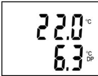
Přístroj poté zobrazuje teplotu a teplotu rosného bodu (řádek označený zkratkou DP).
