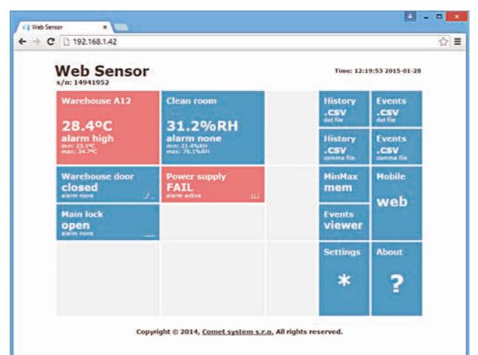
**Aktuální měřené hodnoty** jsou dostupné on-line přímo ve webovém prohlížeči odkudkoliv, stačí pouze zadat IP adresu. Krizové stavy jsou signalizovány červeným polem.
