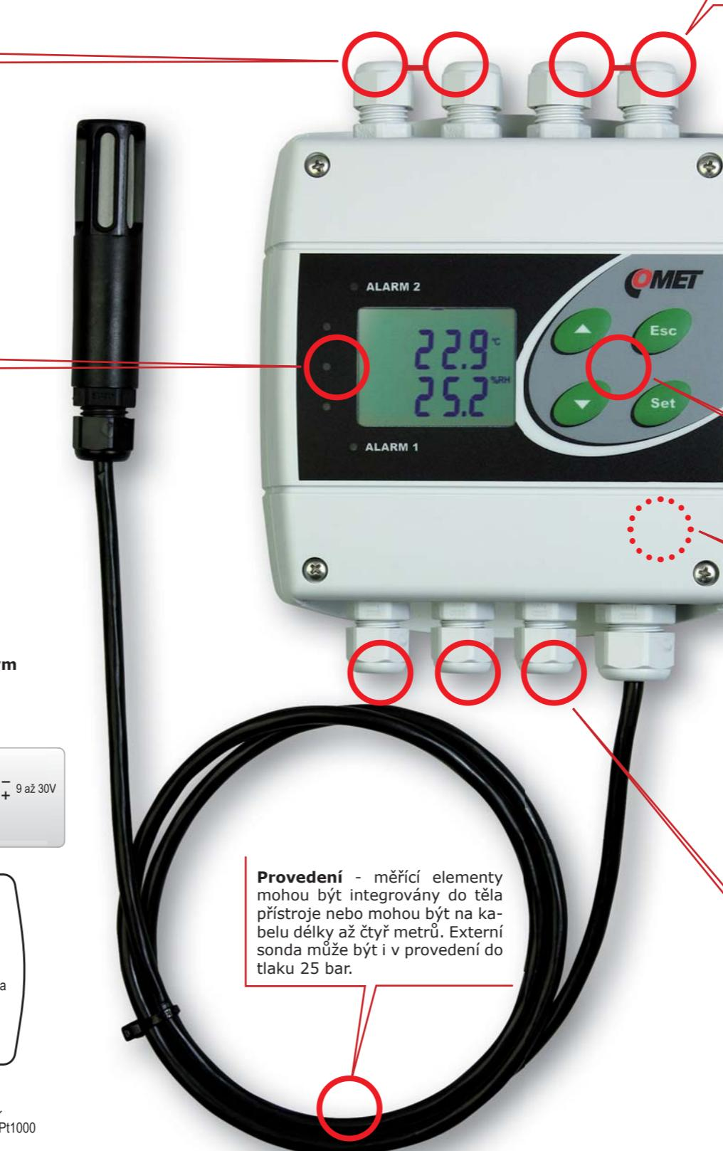
**Relé** - regulátor je vybaven dvěma výstupními relé. Každému z nich je možné přiřadit jednu z měřených veličin nebo „vzdálenou podmínu“, kdy stav výstupních relé je možno vzdáleně ovládat pomocí příkazů komunikačního protokolu Modbus.
