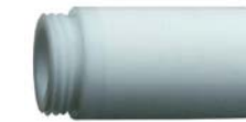
F5300 - Krytka čidel z teflonu (PTFE, bílá barva) se zvýšenou odolností proti stříkající vodě, vodoodpudivý, nenásávkový povrch, nepodléhá korozi. Filtrační schopnost 25µm. Teplotní rozsah -40 °C až +125 °C.
